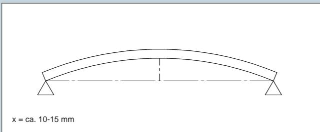
Lieferzustand **Allround Kabelleiter** mit horizontalem Verzug, Begradigung nach Auflegen der Kabel
