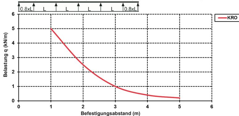
Die im Diagramm aufgeführten Belastungsangaben sind unabhängig von der Lage der Verbinders.
