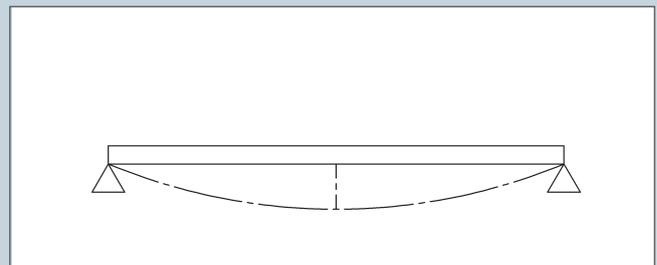
Lieferzustand **Standard Kabelleiter** ohne horizontalen Verzug, Durchbiegung nach Auflegen der Kabel
