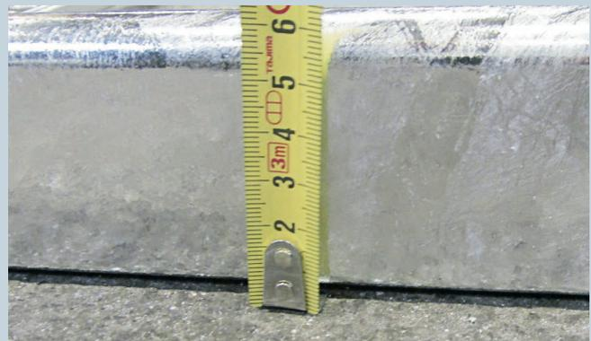
Die werkseitig eingebrachte Vorspannung in der Mitte der KRO.../KRC... sollte im Bereich von ca. 10-15 mm liegen.
