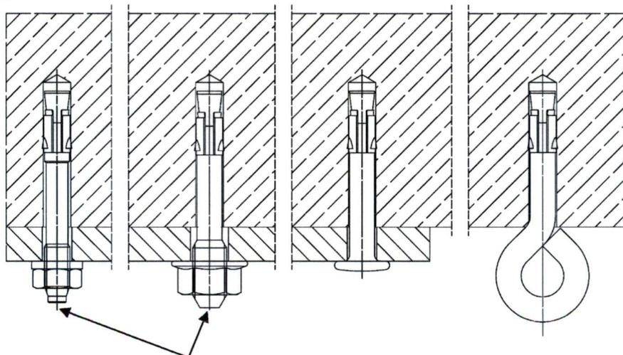
Zusätzliche Markierung nur bei galvanisch verzinktem Stahl für  $h_{ef} = 25$  mm (Zentrierung, Balken oder Punkt)
