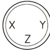
Prägung bei **X**: "O" für  $h_{ef} = 25$  mm
